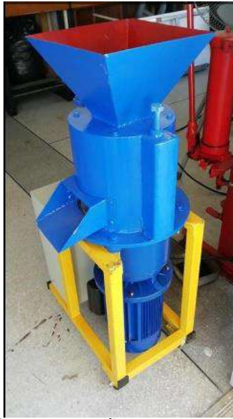
ภาพที่ 4 เครื่องอัดเม็ดเชื้อเพลิงต้นแบบระบบอัตโนมัติ
